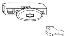
Viene usato per aperture anta ribalta. Permette il blocco dell'apertura a battente.
